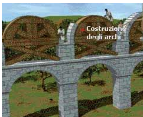
4. sistema di costruzione dell'arco
